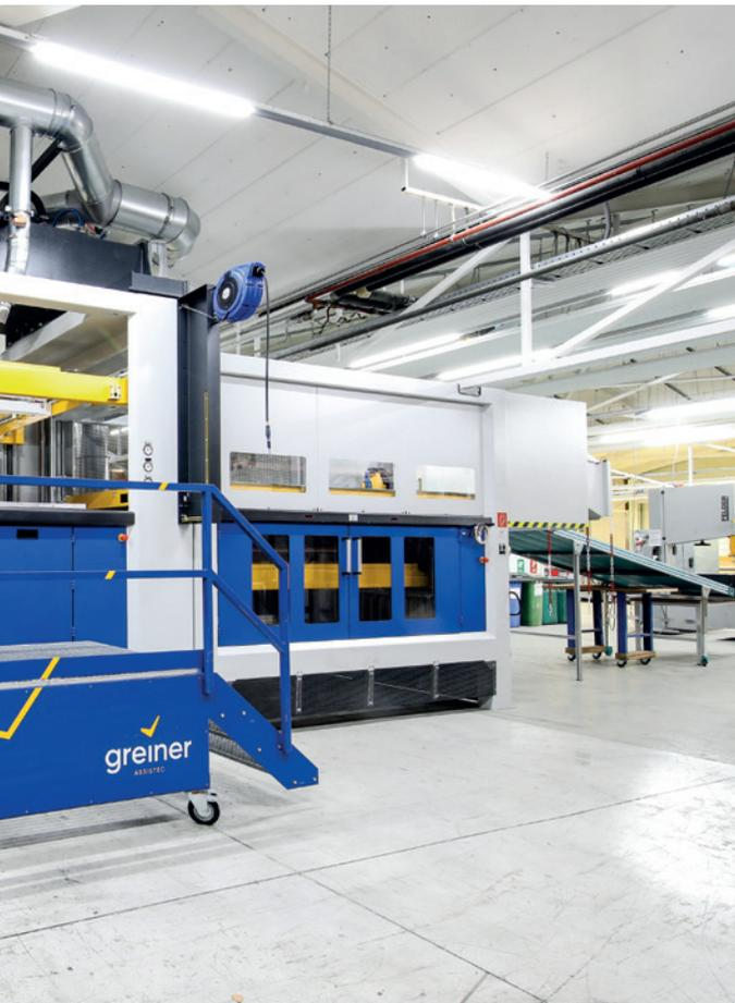
Bereich des Twin-Sheet-Verfahrens haben sich die Experten noch breiter aufgestellt. Mit einer neuen und hochmodernen Anlage können jetzt Kunststoffplatten bis zu einer Dimension von 2.700x1.700 mm tiefgezogen und damit Industriepaletten- und Sonderformate für Großladungsträger abgedeckt werden.
