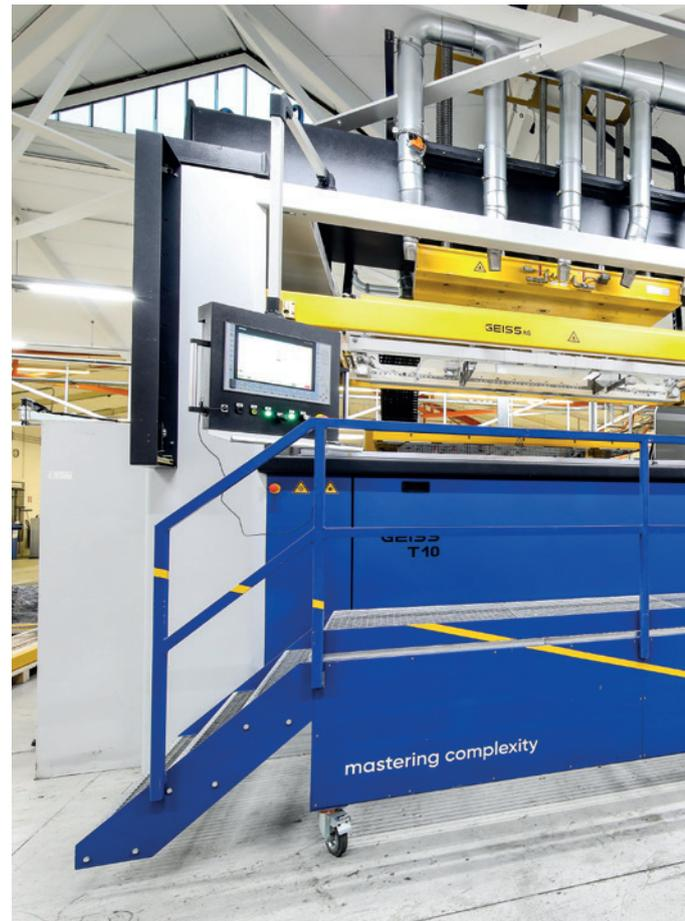
2019 hat Greiner Assistec sein Angebot im Bereich Twin-Sheet-Verfahren erweitert. Nun können Kunststoffplatten bis zu einer Dimension von 2.700 x 1.700 mm tiefgezogen werden.
